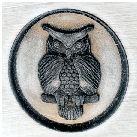
Příklad: 3D gravírování sovy Rozměry: 14,5 x 18,5 mm, hloubka 1,00 mm, vyrobena za 72 minut.
