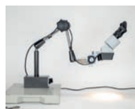
Mikroskop s 10násobným zvětšením pro precizní naváření..
