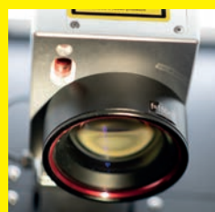
Popisovaná plocha 150 x 150 mm s objektivem 32- PLM0150 (výška obrobku zmenše- ná o 75 mm)
