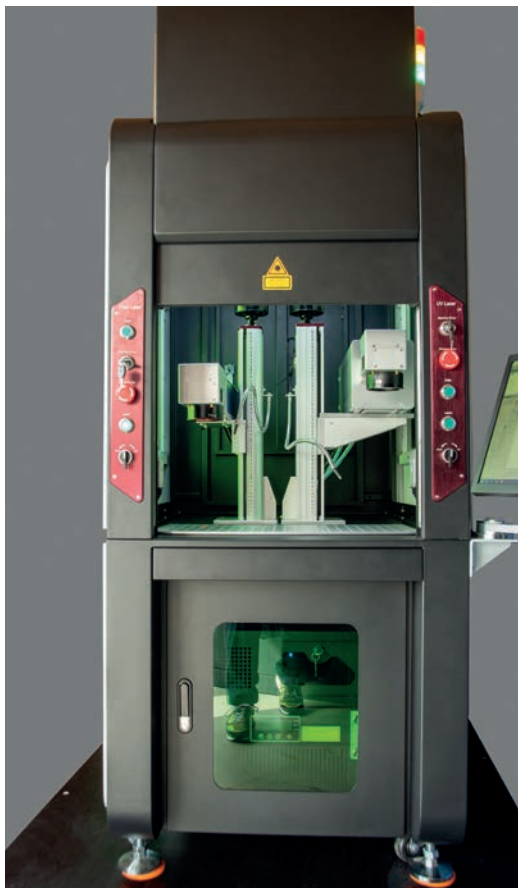
vlevo vidíte vláknový laser, vpravo Uv laser
