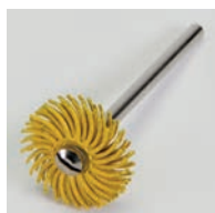
Leštící-brusné kotouče, stopka-Ø 3,00 (4 vrstvý) délka stopky 40 mm, kotouče-Ø 19 mm
