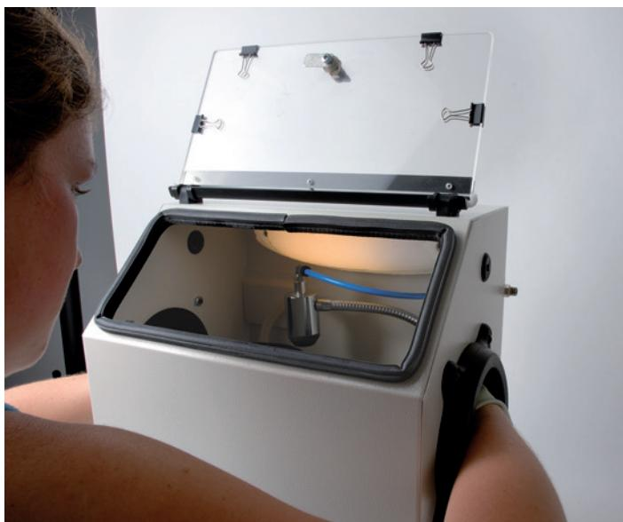
Malá kompletní kabina se 4 mm HM-tryskou, dobrým osvětlením a robustní konstrukcí.
