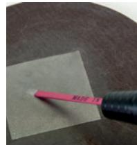
Pravidelné obtahování na diamantové fólii nebo brousku zaručuje bezvadný povrch..
