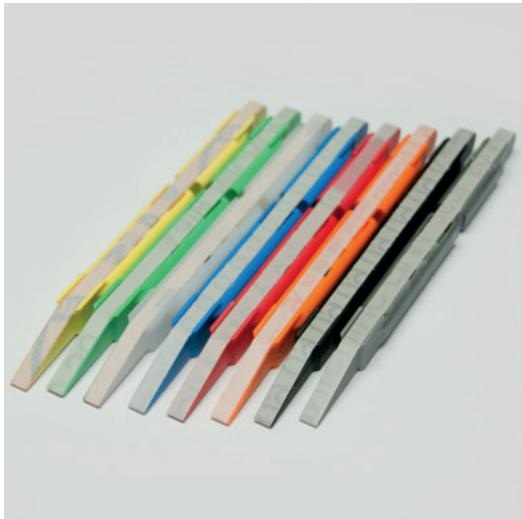
Držáky brusných pásů s brusným mikropáskem jsou ergonomicky tvarované nástroje. Jsou ideální pro čištění po svařování. Nástroj má tři pracovní plochy, klínovitý konec, plochý spodek a oblý konec, ideální pro finišování na každé ploše. Vestavěné pero pomáhá napínat brousící pásky. K dostání s vyměnitelnými brousícími pásky v 8 zrnitostech.
