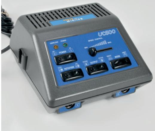
Zde můžete připnout dva mikromotory, které se používají střídavě. Tím ušetříte čas, odpadá výměna nástrojů. Motory jsou pravo i levo točivé. Plynulé regulování otáček posuvným ovladačem. Elektronická kontrola zajišťuje konstantní otáčky i při zatížení.
