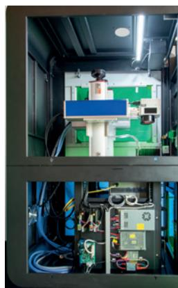
Ve spodku soklu se nachází zdroj laseru, celé ovládání, počítačový systém a v případě potřeby také chladicí zařízení.
