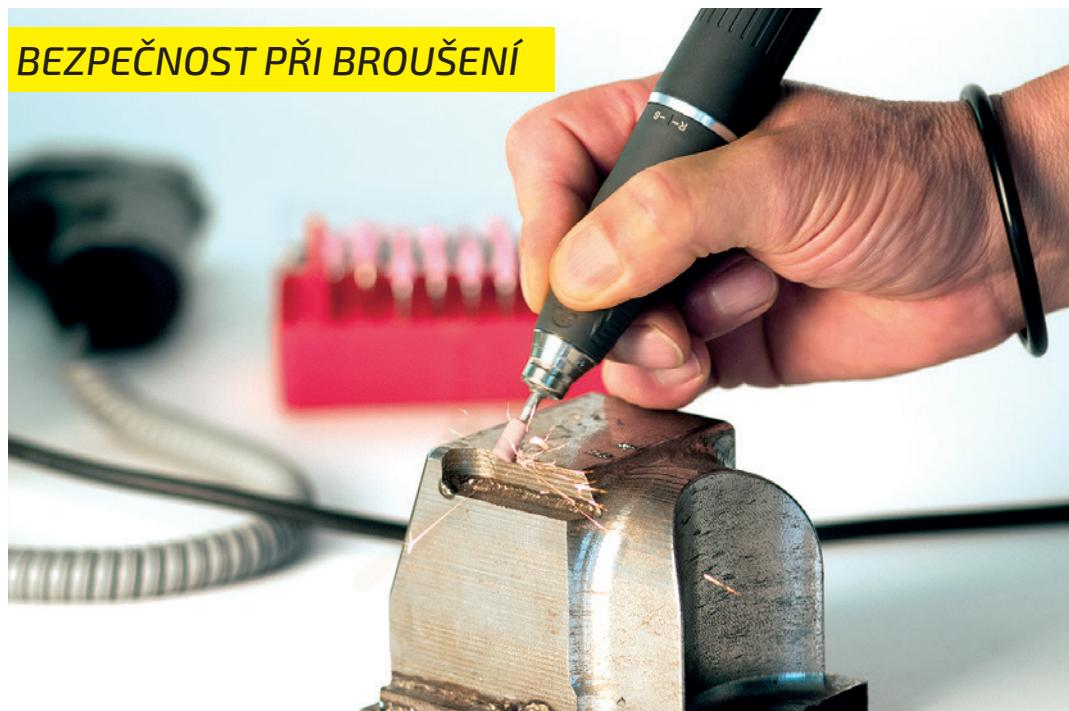
Naše brousící tužky jsou vyrobeny podle nejnovějších technických poznatků, pečlivě kontrolovaný a odzkoušeny. Jejich bezpečnost odpovídá normě EN 12413. Tužky jsou vyráběny jako keramické nebo pryskyřičné s rychlosí až do 50 m/s. Věnujte pozornost pokynům u jednotlivých skupin. Maximální rychlosí je omezena následujícími kritérií:
