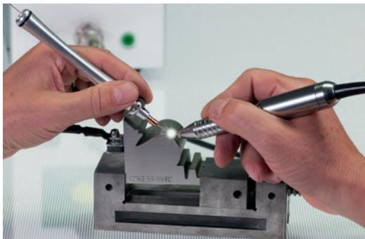
Držák laserového drátu s manuálním posunem
