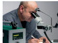
mikroskop s 10násobným zvětšením pro precizní naváření.
