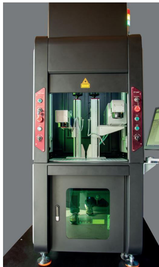
vlevo vidíte vláknový laser, vpravo Uv laser
