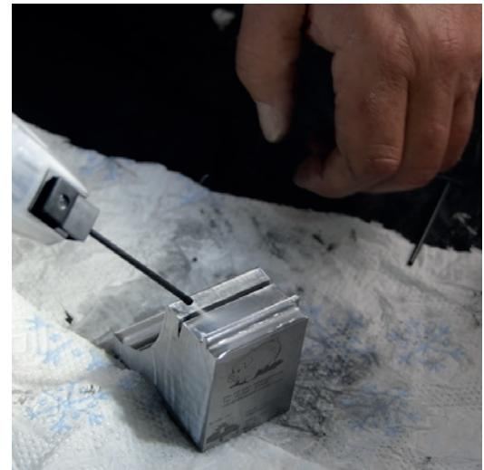
Hluboké štěrbiny a vývrtky vyčistíte s pomocí praktického multifunkčního rozprašovače obzvlášť pečlivě a jednoduše.
