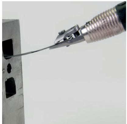
Galvanicky vázané diamantové pilníky jsou velice dobře formované a potřebují malou přítlačnou sílu. Velká přítlačná síla způsobuje rychlé opotřebení, ale ne větší obrobiteľnost.
