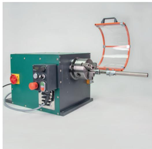
Ovládací pult je možné namontovat na různá místa, otáčky jsou plynule nastavitelné.
